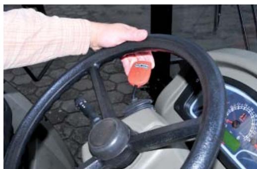
фото: изменение направления движения при помощи рычажка под рулем без использования сцепления
