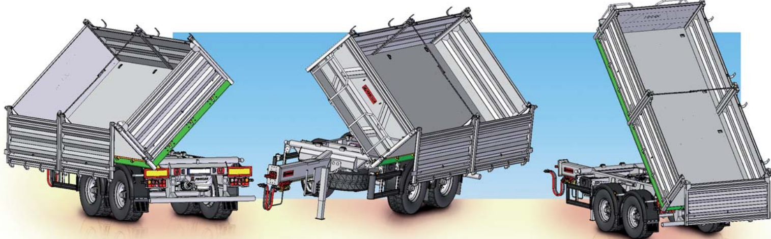
фото: использование гнутых профилей на бортах позволило укрепить их без приварки дополнительных укрепляющих элементов
