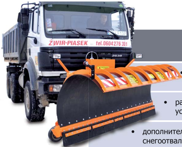
фото: снегоотвал убирает снег в двух направлениях – влево и вправо
