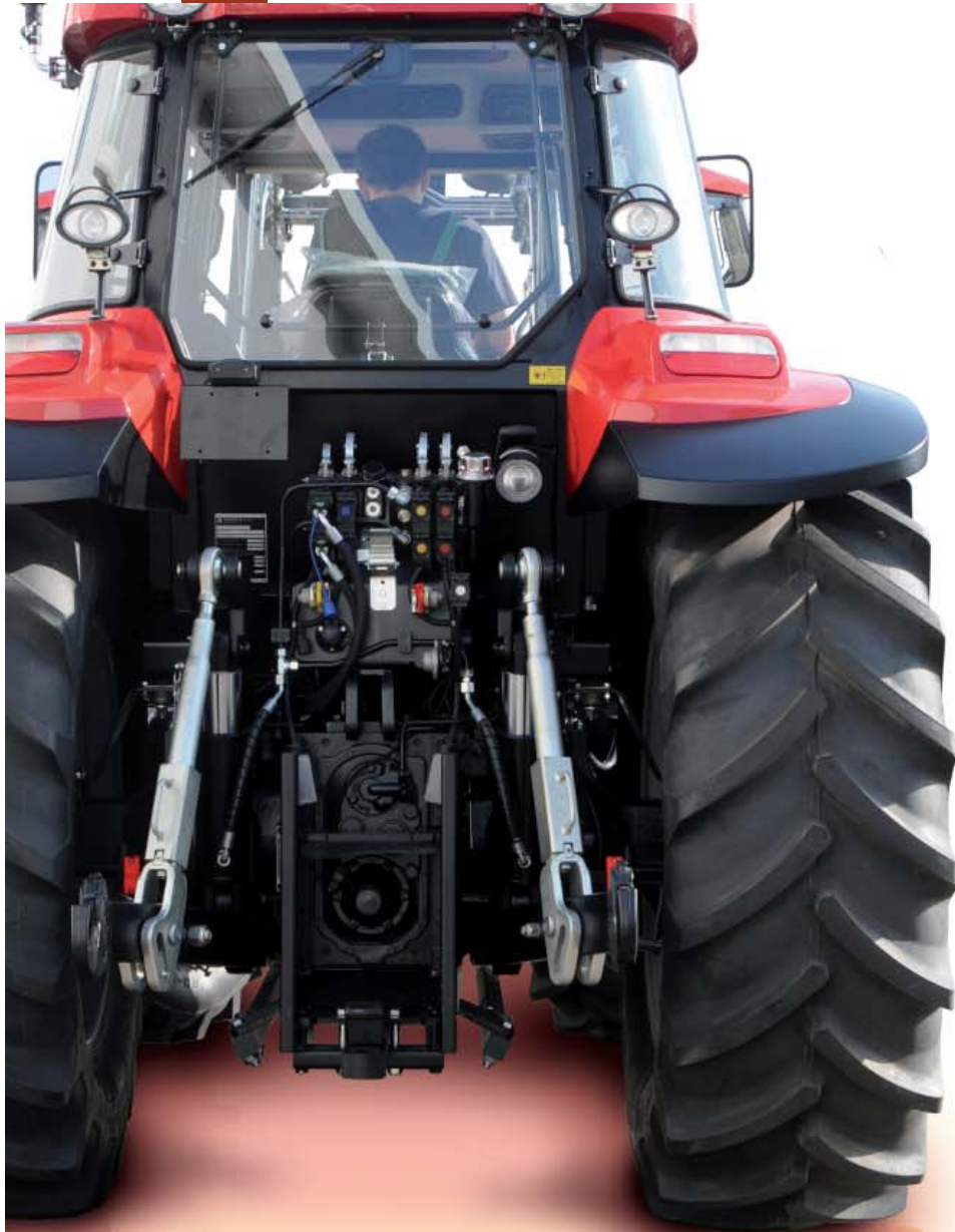
фото: два гидроцилиндра диаметром 100 мм обеспечивают грузоподъемность СТН 9200 кг
