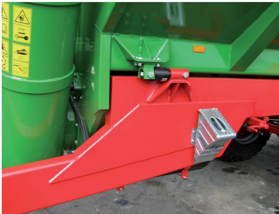
фото: весовая система (чёрный элемент)
