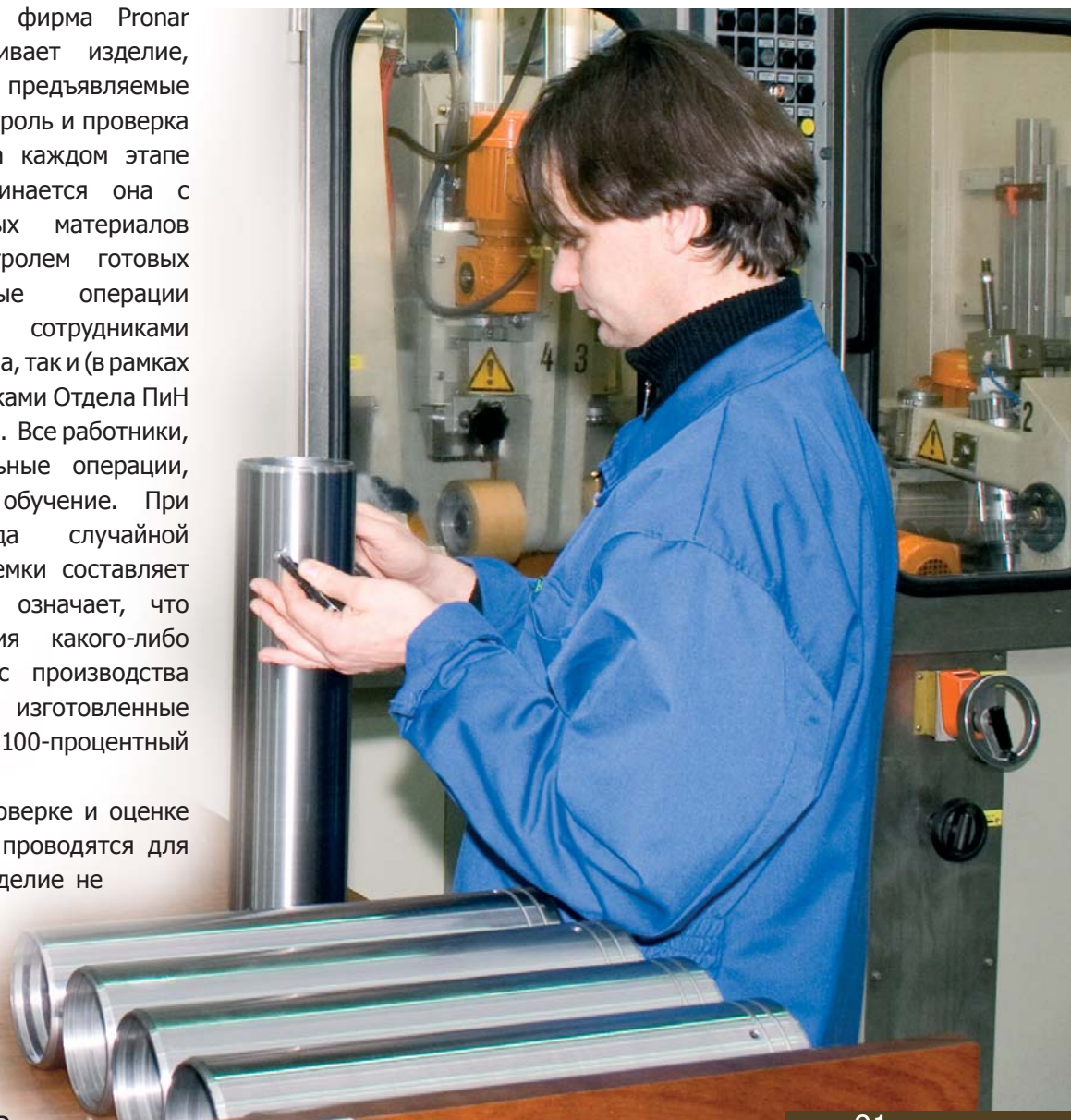
фото: контроль диаметра на шлифовально-полировочной линии
